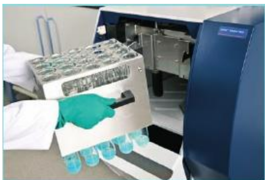
Просто загрузите ваши стойки для образцов прямо из дигесторного блока, и Kjeltec™ выполнит точный анализ без участия персонала в течение более четырех часов.
