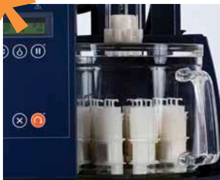
12-местный держатель образцов для гидролиза для автоматической обработки и высокой производительности.
